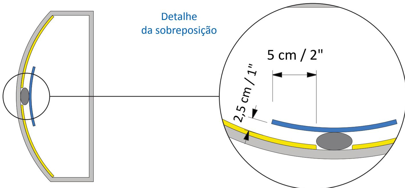
Na sobreposição do aço e painel balístico na maçaneta da porta, coluna e teto, deverão ser respeitadas as mesmas distâncias entre os materiais, ou seja, 2,5 cm (o 1 polegada). Assim como sempre que houver necessidade de sobrepor diferentes partes do painel balístico *Neoflex*® em qualquer parte do veículo, deverá ser respeitada a sobreposição mínima de 5 cm (o 2 polegadas)
